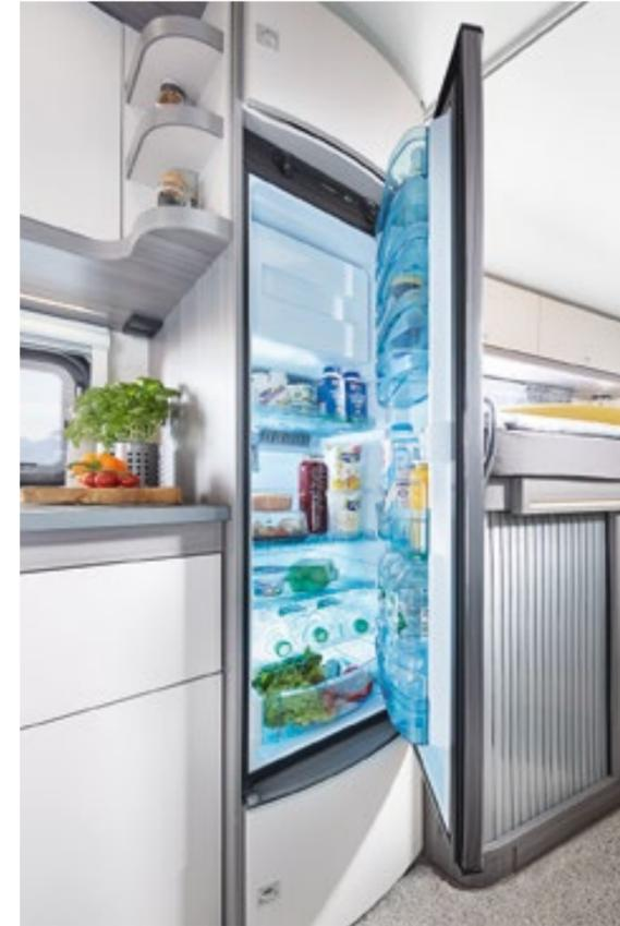
Im Fach unter dem Kühlschrank verstauen Sie gut zugänglich Vorratsdosen und Konserven. Der Kühlschrank kann über die 230-V-Einspeisung und unterwegs per Gas oder 12 Volt betrieben werden.
